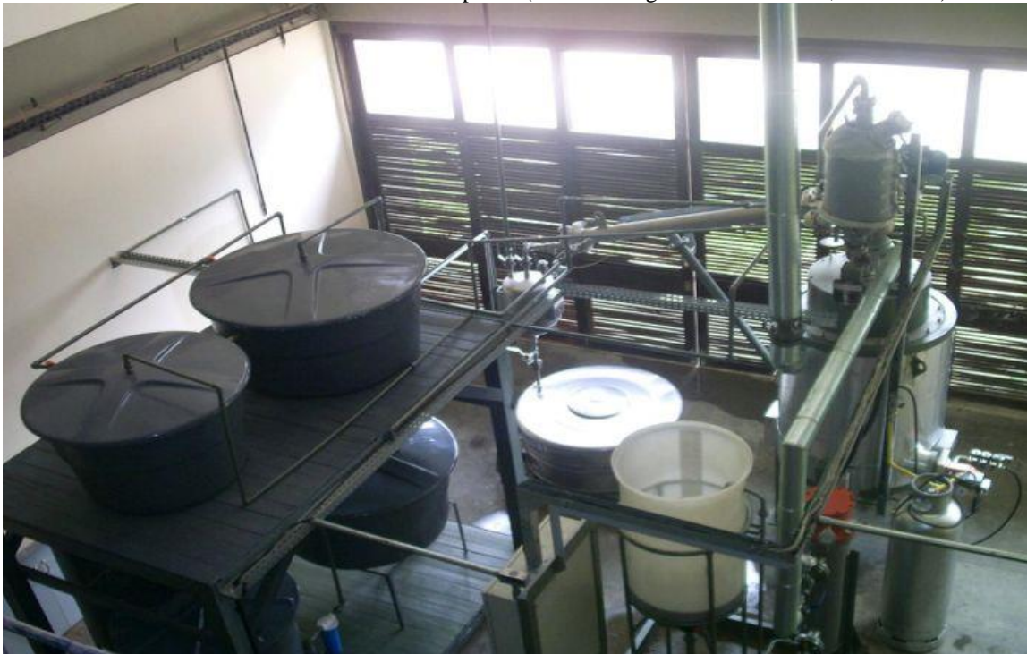
Figura 2. Aparelho experimental (Unidade de Craqueamento Térmico-Catalítico) para a pirólise de resíduos dentários reticulados base de PMMA em escala piloto (Haroldo Jorge da Silva Ribeiro, Tese 2021).
