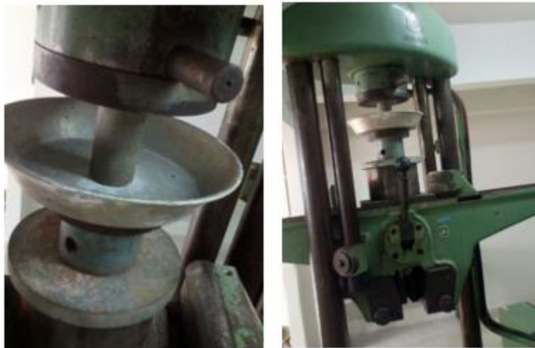
Figura 4: Determinação da resistência à compressão simples das argamassas
