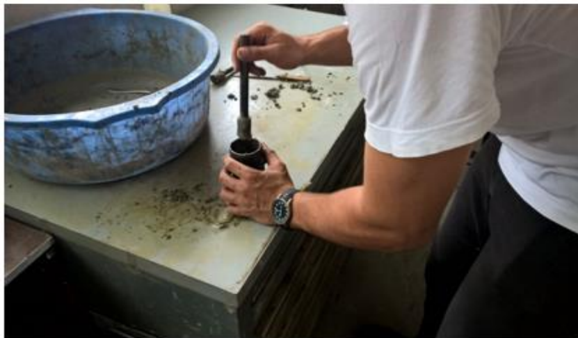
Figura 2: Moldagem dos corpos de prova de argamassa utilizados neste estudo
