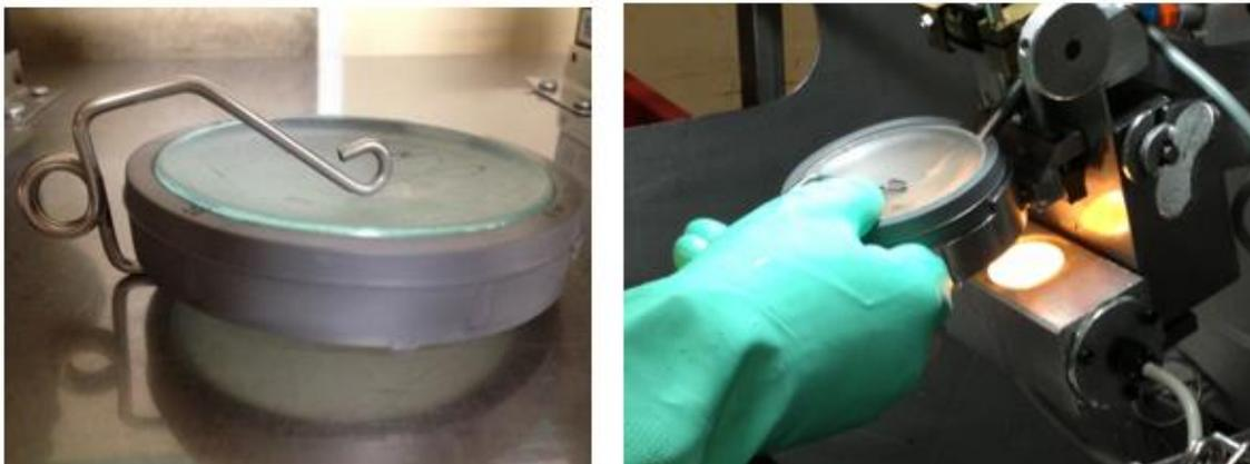
5 – Polimerização, que ocorre em estufas que podem ser de água ou de ar, de acordo com o tipo de lente a ser produzida. O tempo de permanência nas estufas também varia de acordo com o tipo de lente que se deseja produzir. Após a polimerização, ocorre o processo de desmontagem, onde a lente já polimerizada é retirada do sanduíche (PARRON *et al.*, 2011).
