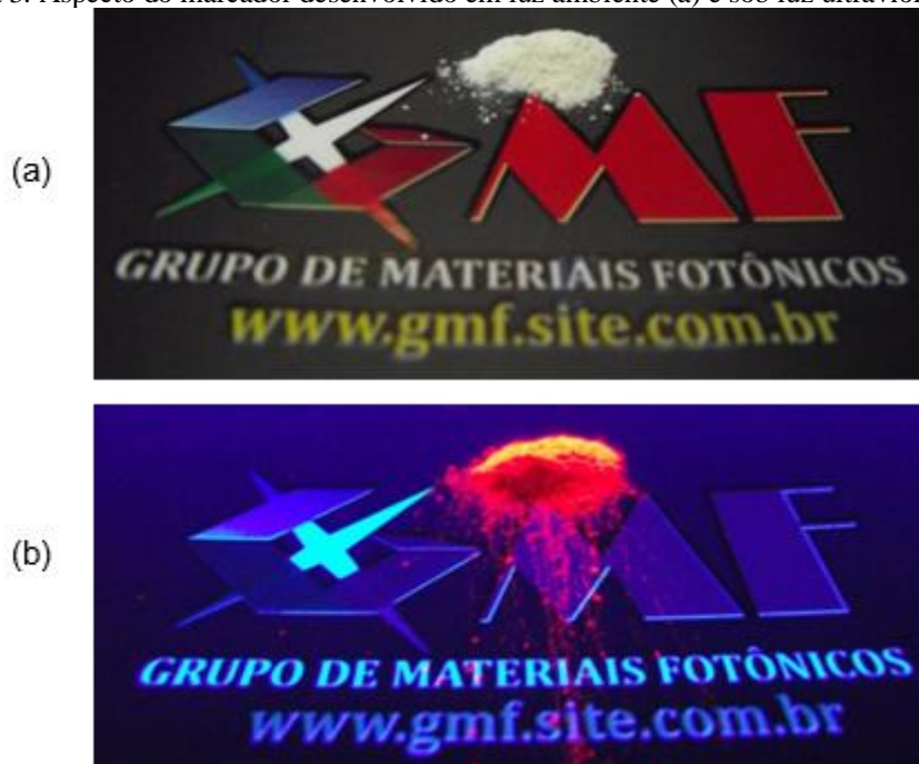
Figura 3. Aspecto do marcador desenvolvido em luz ambiente (a) e sob luz ultravioleta (b)
