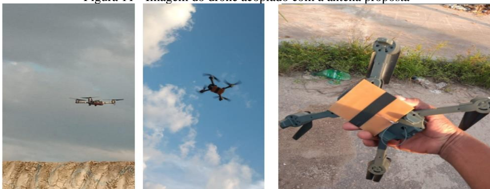
Figura 11 - Imagem do drone acoplado com a antena proposta
