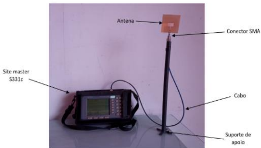
Figura 9. Setup de medição da antena
