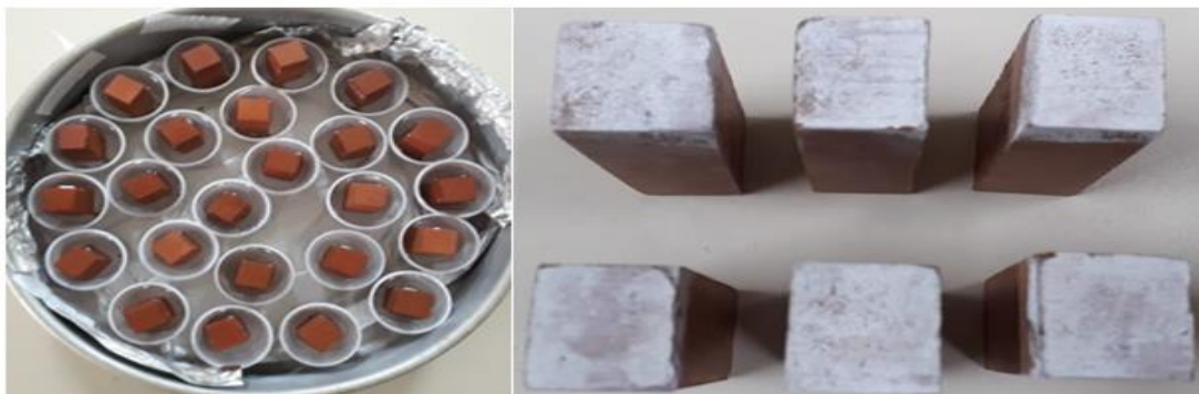
Figura 2 – Amostras imersas em água (esquerda) para a formação de eflorescência (direita).
