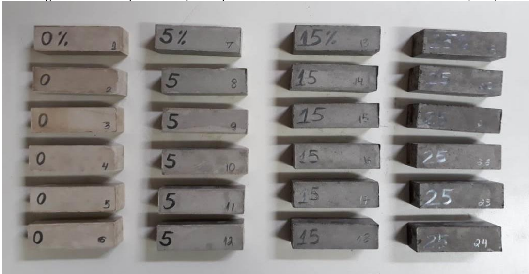
Figura 1 – Coloração dos corpos de prova a verde com diferentes teores de resíduo (%m.).
