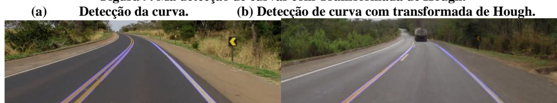
Figura 9. Má detecção de curvas com Transformada de Hough.
