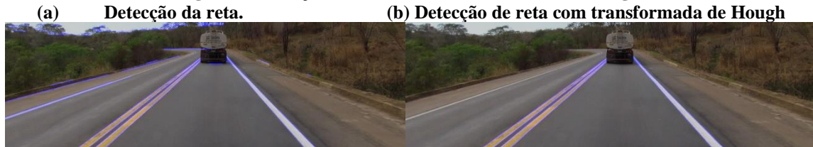
Figura 7. Detecção de retas com Transformada de Hough.
