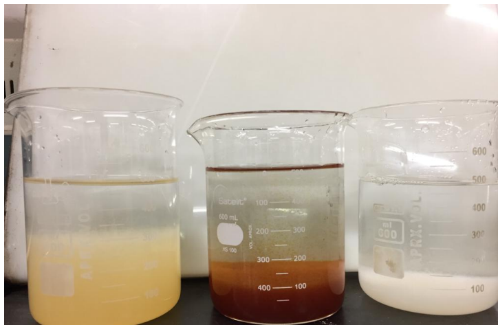
Figura 1. Lodo adensando para diferentes coagulantes. Da esquerda para direita, sulfato de alumínio, cloreto férrico e PAC.
