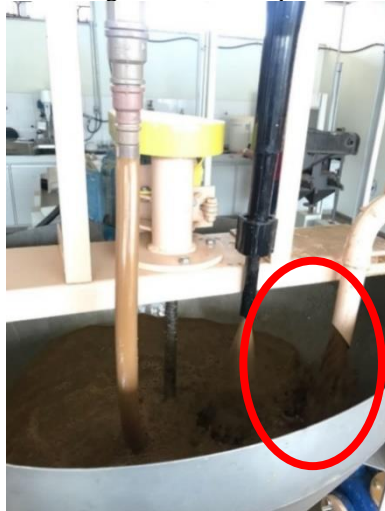
Figura 11 - Descarga em cone do apex , hidrociclone 1.
