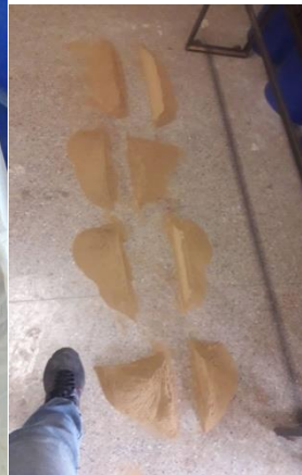
Figura 3 - Pilha de homogeneização após o quarteamento.
