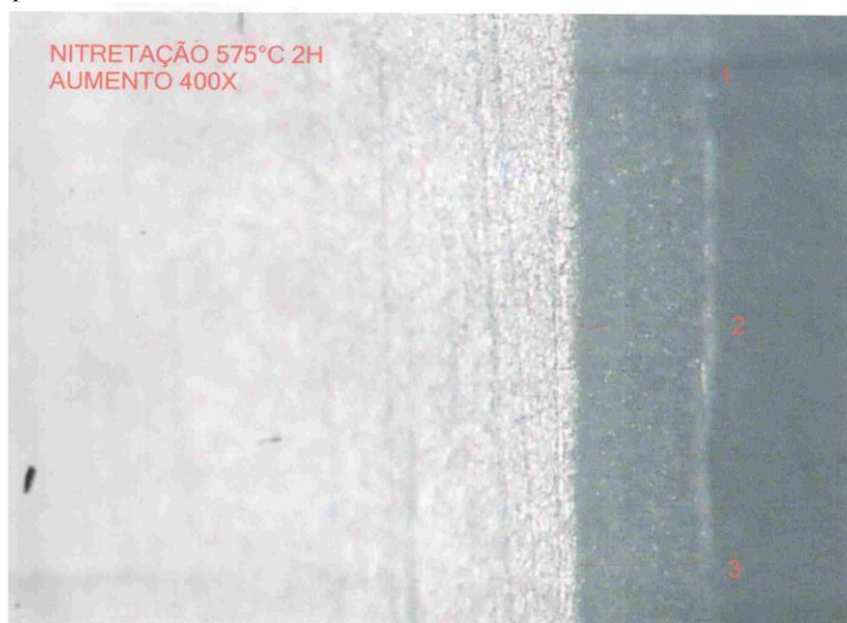
Figura 4 - Micrografia da amostra ao Microscópio Óptico Digital, mostrando a camada branca nitretada em banho de cianeto, por 2:30 h.
