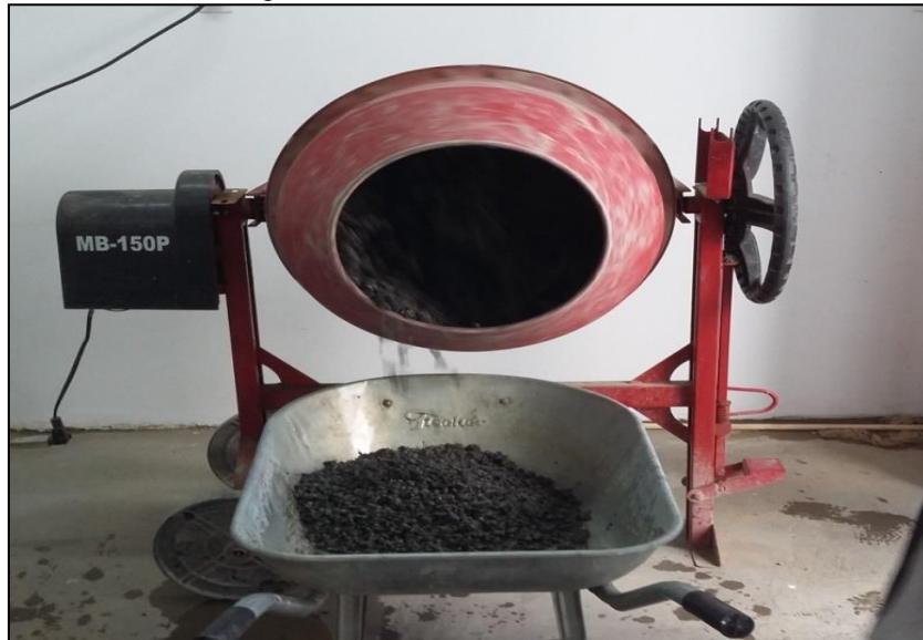
Figura 2: mistura da massa de concreto
