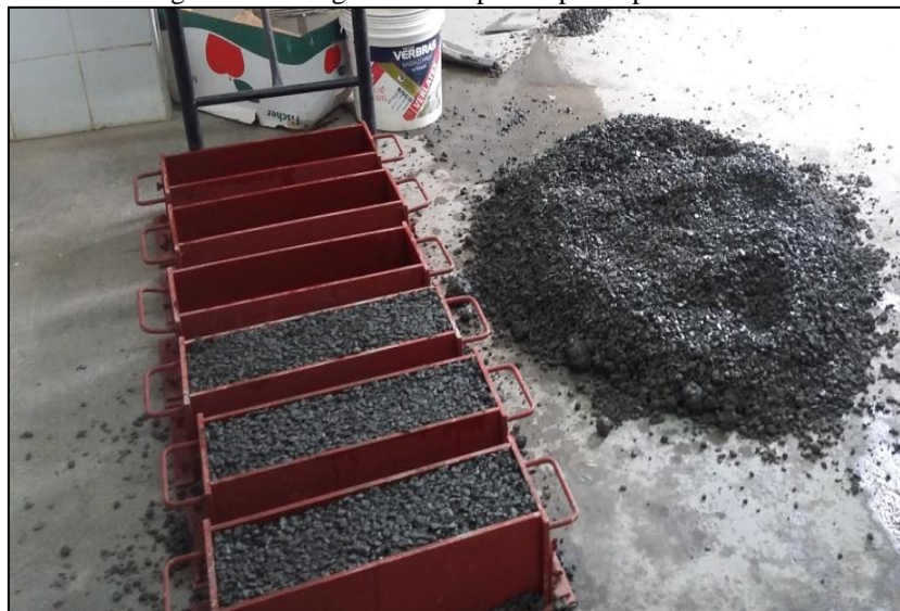
Figura 3: moldagens dos corpos de prova prismáticos.
