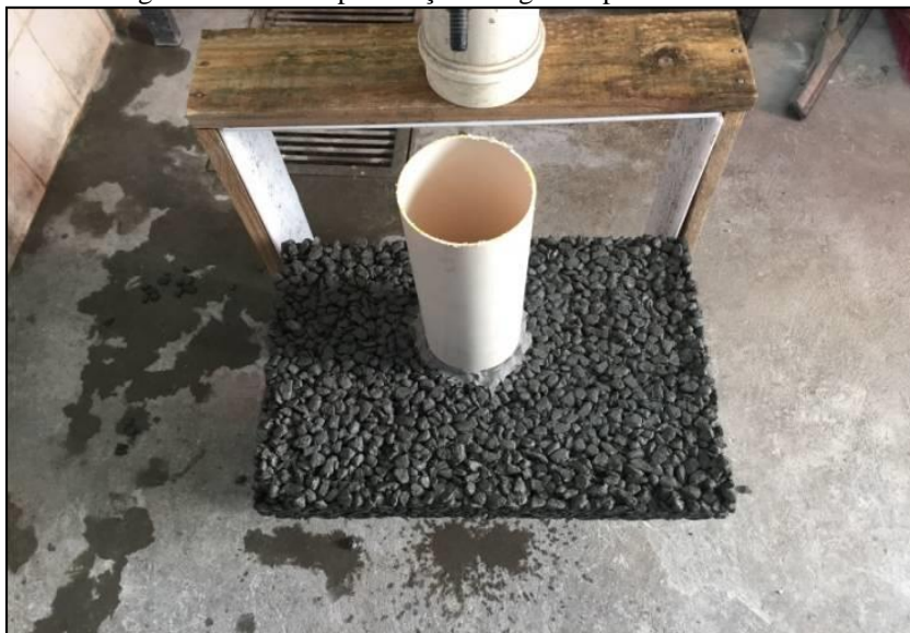
Figura 07: teste de percolação da água na placa de concreto
