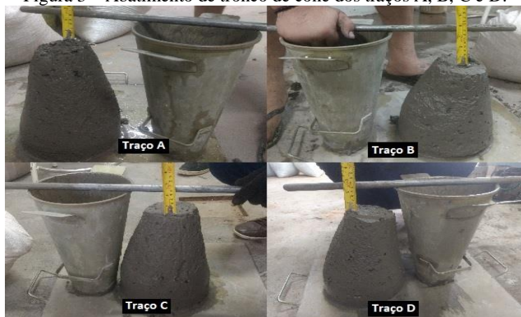
Figura 3 – Abatimento de tronco de cone dos traços A, B, C e D.
