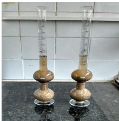
Figura 1: Massa específica do agregado miúdo por meio do frasco Chapman
