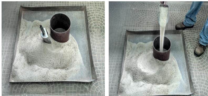
Figura 2: Determinação da massa unitária no estado solto
