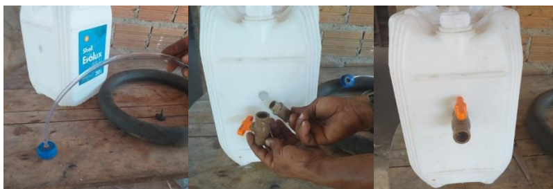
Figura 3- Acoplação da mangueira e do registro de água no tambor
