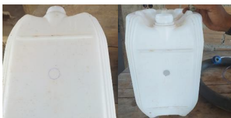
Figura 2- Corte de um círculo no tambor Fonte: Próprio autor
