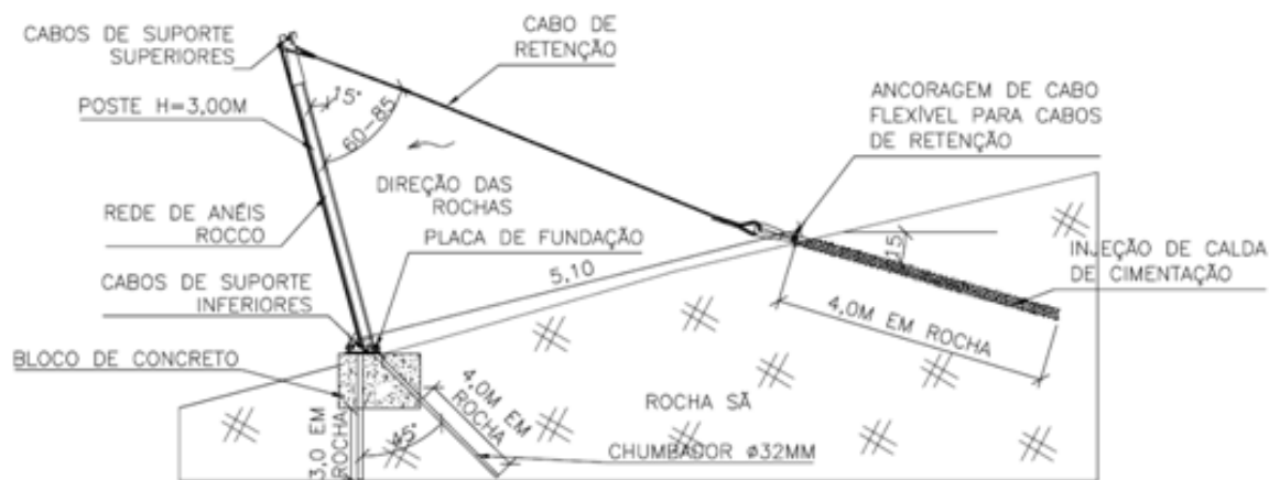
Figura 4: Perfil esquemático das primeiras barreiras flexíveis propostas.
