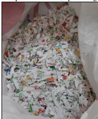
Figura 2: PP pós-consumo, oriundo de copos de bebidas, após lavagem, secagem e corte manual.
