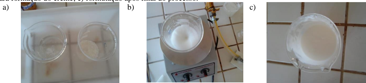
Figura 1. Preparo da formulação: a) fase aquosa a esquerda e fase oleosa a direita; b) processo de agitação para formação do creme; c) formulação após final do processo.
