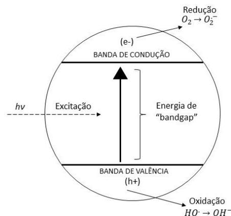
Figura 3 - Esquema dos princípios da fotocatalise heterogênea.
