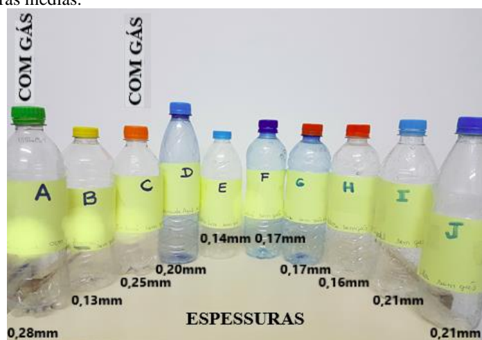
Figura1: Amostras de garrafas PET pós-consumo, descartadas na região metropolitana do Recife, com suas respectivas espessuras médias.
