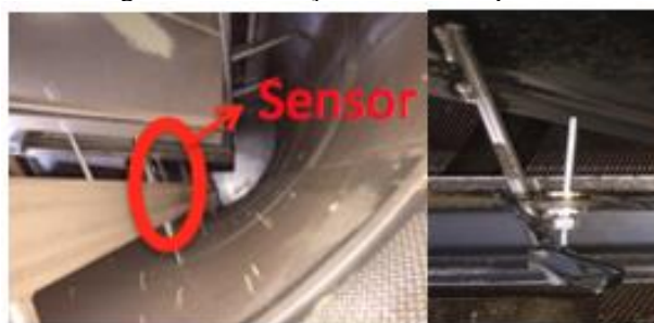
Figura 4. Localização Sensor Temperatura
