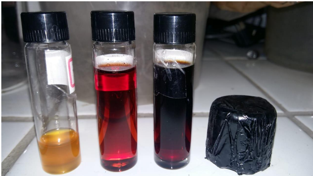
Figura 2: Frações de destilação [gasolina (amarelo), querosene claro (vermelho) e querosene (vermelho escuro) - combustíveis fósseis de temperatura de ebulição semelhante à faixa de temperatura] e fundos [Rafinate (sólido preto)] obtidos por destilação fracionada
