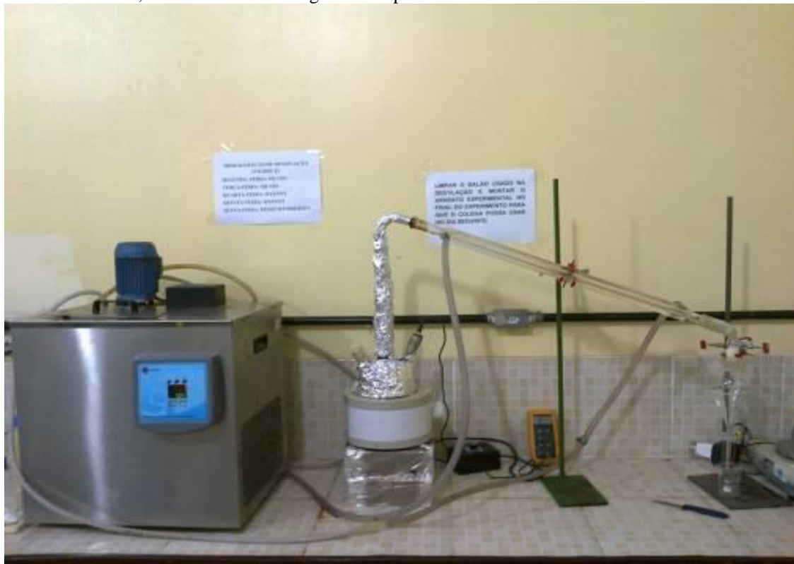
Figura 1: Coluna de destilação em vidro borossilicato Vigreux de 500 ml, manta de aquecimento elétrico, banho de criostato, condensador de Liebig e funil separador.
