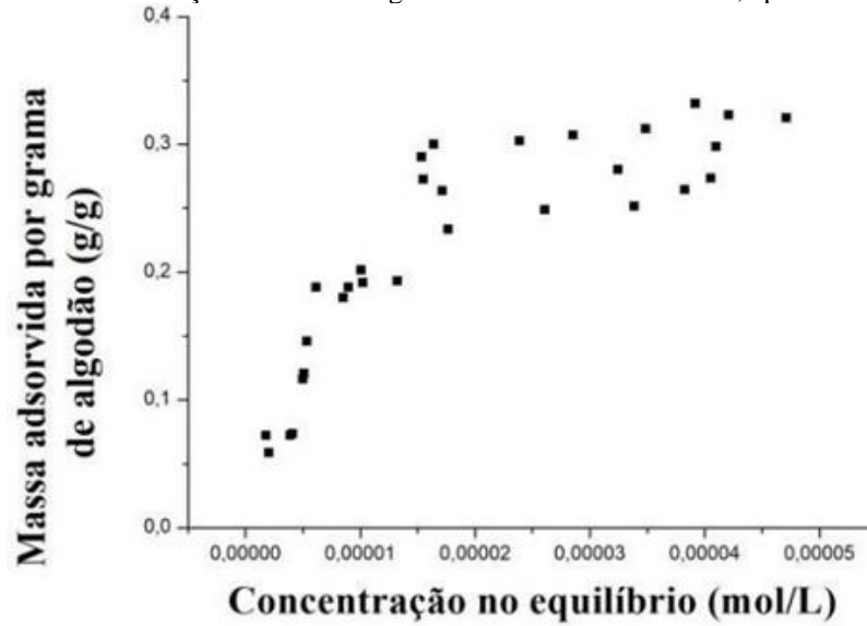
Figura 2 - Isoterma de adsorção de AM em algodão tratado com NaOH 1M, após 4 horas; T = 30 °C.
