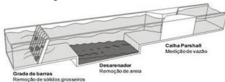
Figura 2: Sistema de Tratamento Preliminar
