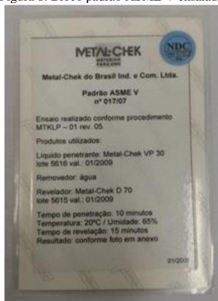
Figura 8: Bloco padrão ASME V ensaiado.
