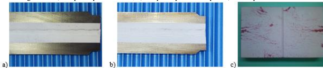
Figura 10: a) Corpo de prova de raiz, b) Corpo de prova de topo e c) Bloco padrão ASME V.
