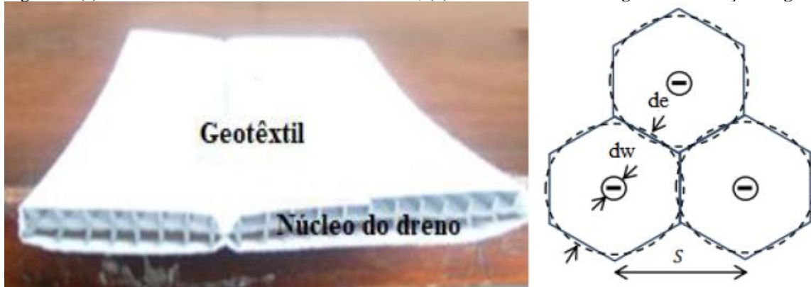
Figura 1. (a) detalhe Geodreno dimensões 5 x 100 mm, (b) detalhe da malha trinagular de cravação do geodreno.
