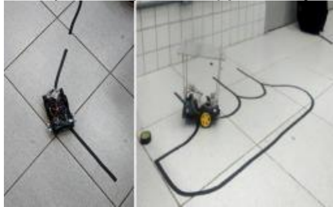
Figura 5: Testes em situações de bifurcação (à direita) e gaps na linha de percurso (à esquerda).
