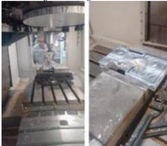
Figura 3: Usinagem do Chassi
