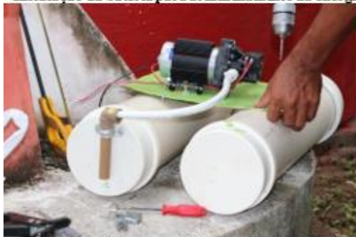
Plataforma flutuante da Motobomba fotovoltaica
