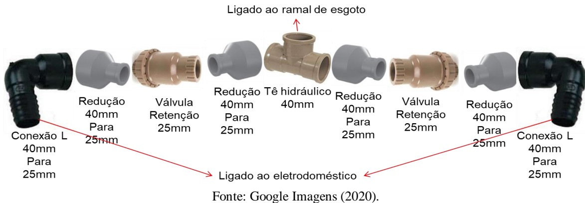
Figura 2 – Vista explodida dos componentes utilizados na construção do segundo protótipo.
