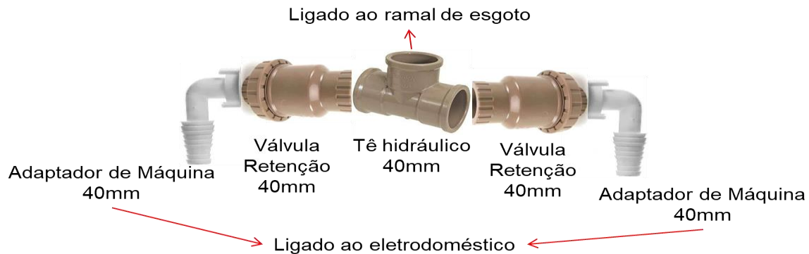
Figura 3 – Vista explodida dos componentes utilizados na construção do terceiro protótipo.
