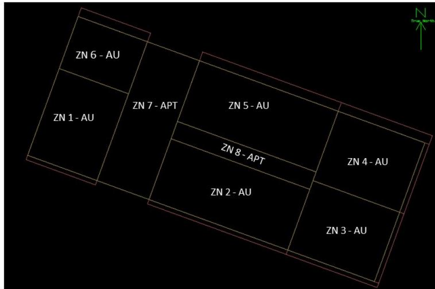
Figura 3 – Divisões das zonas térmicas do pavimento tipo.
