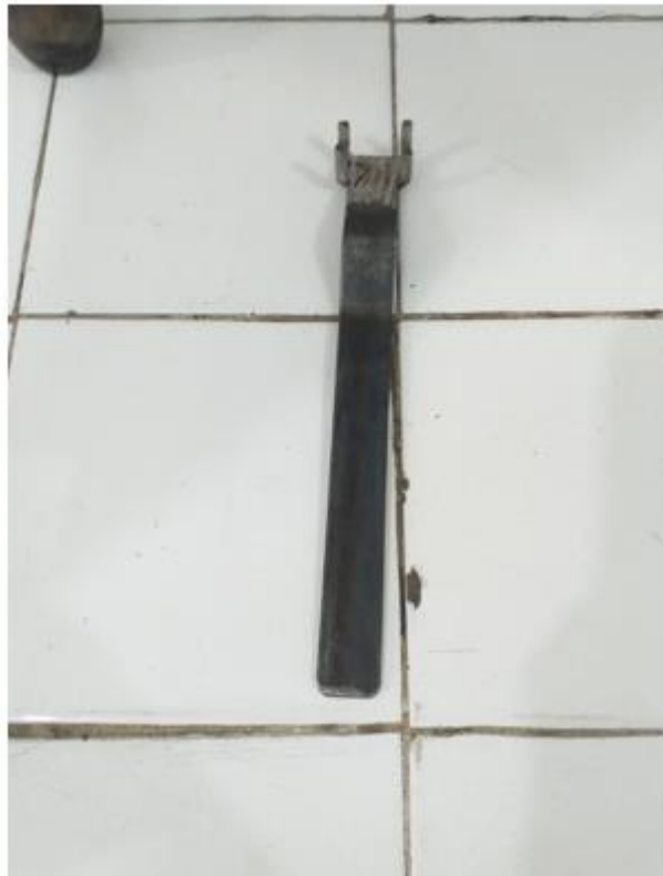
Figura 4 - Alavanca para ser adaptada a torneira de saída de gás, para que o aluno tivesse autonomia em relação a abertura e fechamento do gás.
