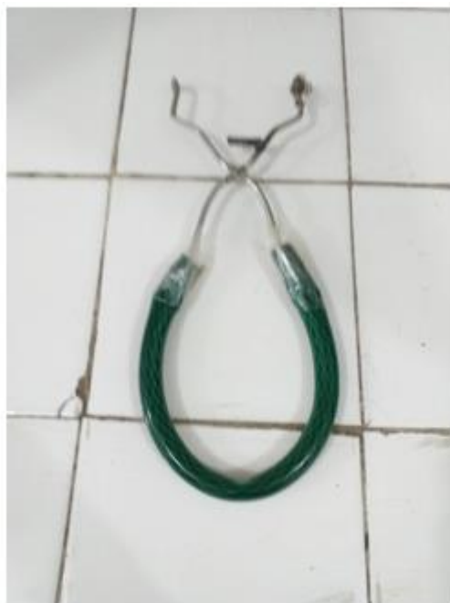
Figura 5 – Pinça de aço com duas adaptações: trava de ferro (para não quebrar o bequer) e tubo de plástico para tornar a alça maleável.
