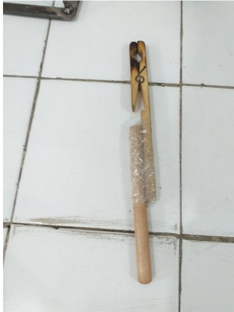
Figura 6 - Pinça de madeira com um prolongamento para ficar mais confortável e seguro para o aluno.
