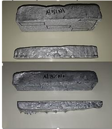
Figura 6 – Obtenção da seção transversal para análise macroestrutural
