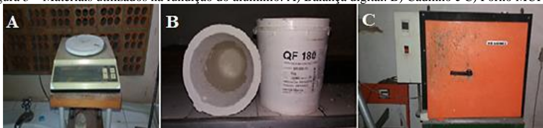
Figura 3 – Materiais utilizados na fundição do alumínio: A) Balança digital. B) Cadinho e C) Forno MUFLA.
