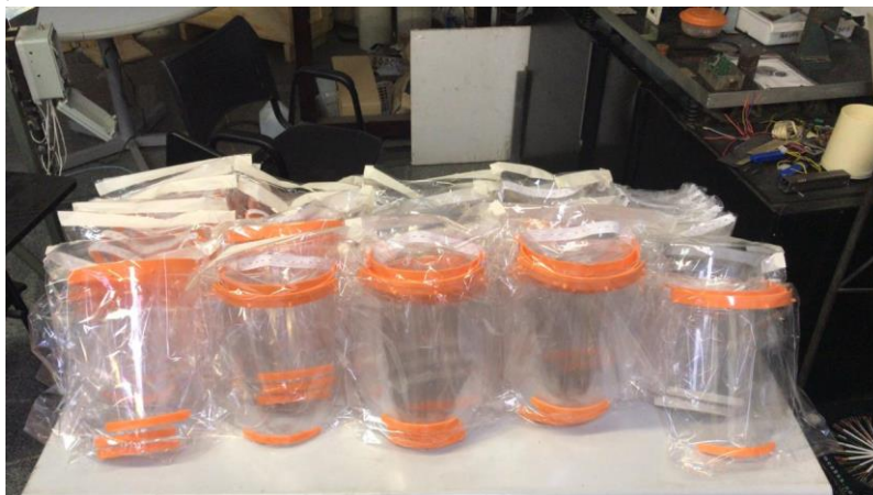
Fig. 1 – Face shields confeccionados por manufatura aditiva. A estrutura de cor laranja é obtida a partir de filamentos de PLA.
