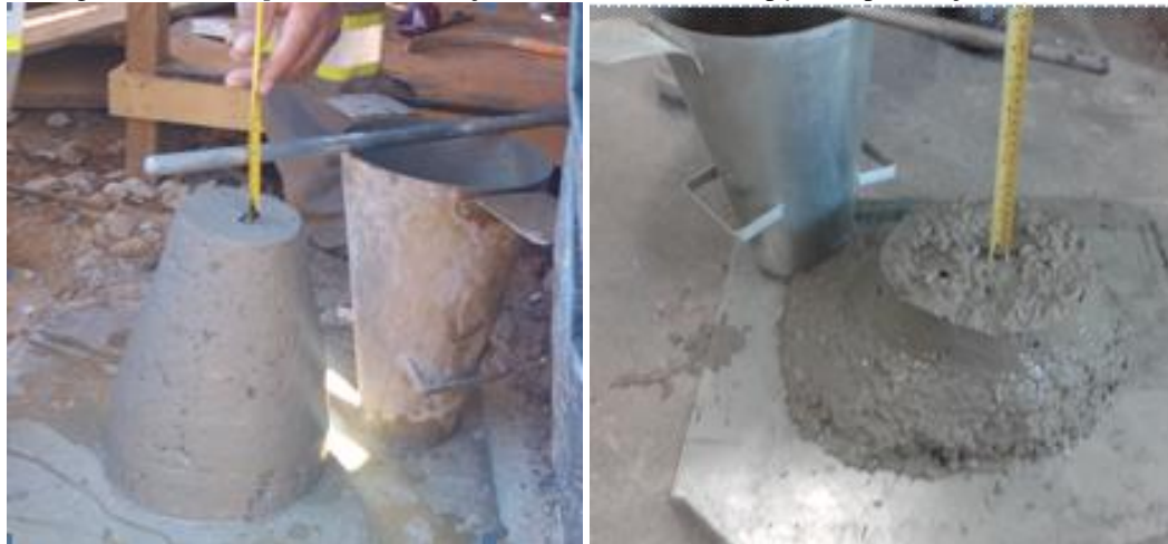
Figura 1. (a) Slump inicial sem adição de aditivos, (b) Slump final após adição de aditivos.
