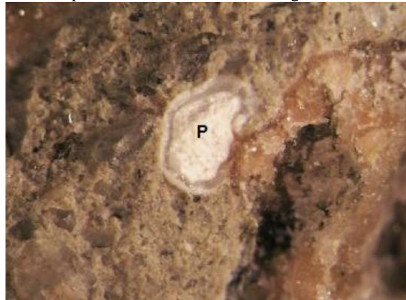
Fig. 5: Detalhes do concreto ao microscópio óptico com ampliação 100x, mostra gel da reação desenvolvendo-se ao redor do agregado graúdo e na foto 15 mostras, a luz de um ao microscópio óptico com ampliação 100x, detalhes de um poro da argamassa preenchido por cristais aciculares de etringita
