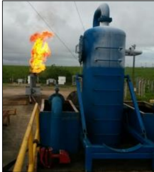
Figura 8: Choke-Trailer e queimador em funcionamento ao fundo.
