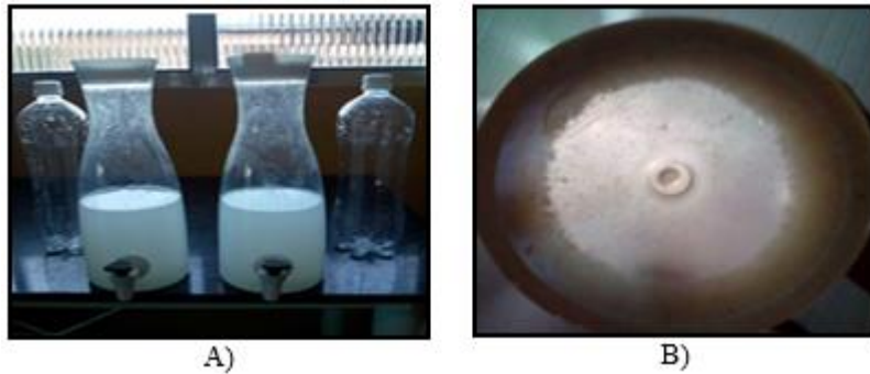
Figura 8. A) Vasilhame contendo a água a ser tratada; B) Decantação das partículas sólidas presente na água.
