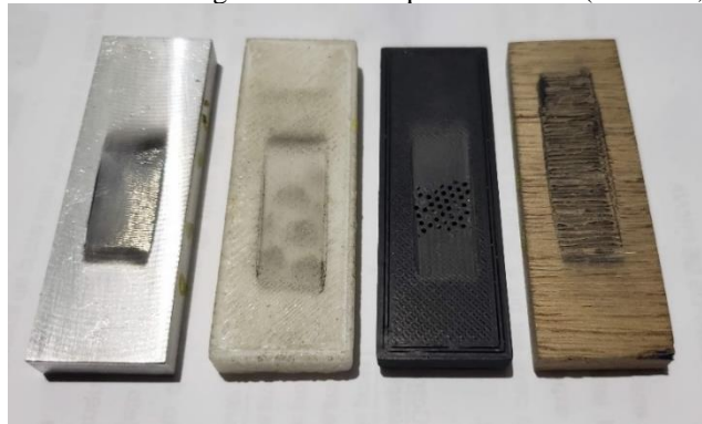
Figura 13. Perfis de desgaste deixados após os ensaios (Do autor, 2019).
