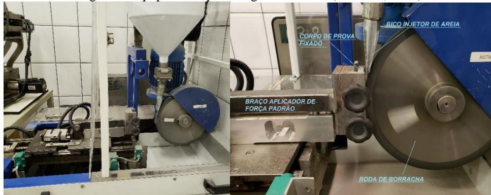
Figura 8. Equipamento para desgaste abrasivo (Do autor, 2019)
