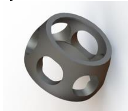
Figura 2. Desenho da gaiola homocinética obtido com a medição tridimensional.
