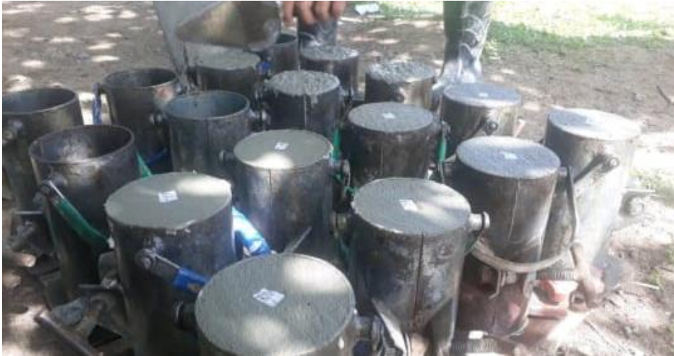
Figura 2 - Moldagem dos corpos de prova
