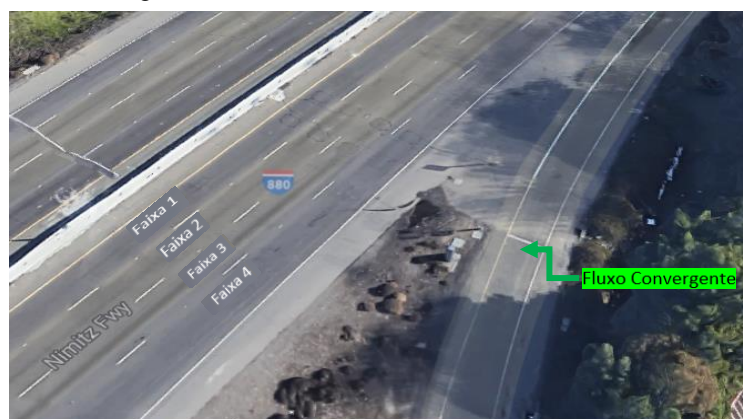
Figura 4: Nomenclatura das faixas de rolamento.
