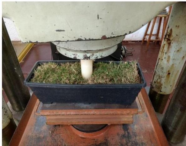
Para a avaliação da resistência mecânica do solo a penetração, utilizou-se o penetrógrafo com monitor/registrator semiautomático de resistência a penetração de solo modelo Penetrographer SC-60, sendo coletados os dados de resistência antes e posteriormente a aplicação da compactação artificial, sendo os valores obtidos na camada de 0 – 0,10 m de profundidade.
