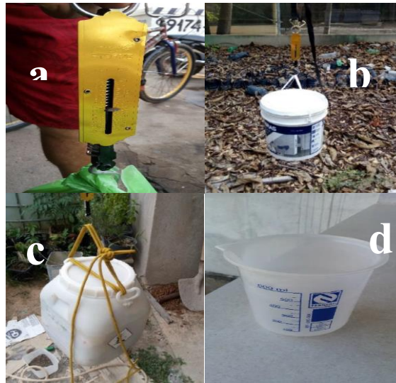
Figura 2: (a) balança tipo gancho; (b) baldes com tampa, com volume de 18L e 30L, (c) recipientes fechados com tampa de 65L; (d) béquer em polietileno.
