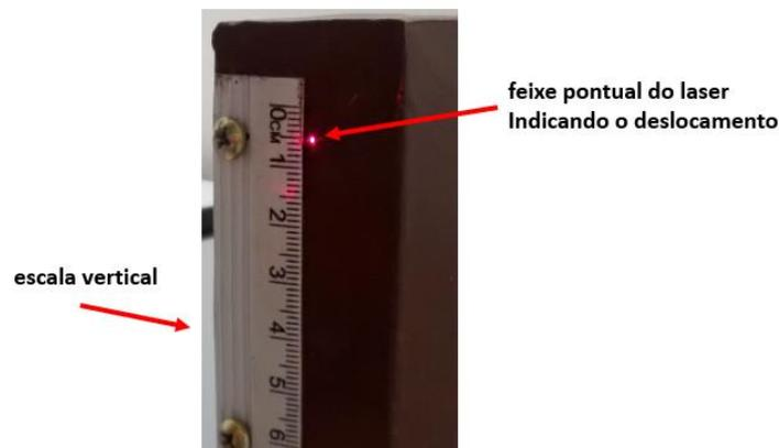
Depois de medir os deslocamentos provocados por diferentes valores de carga, os resultados foram comparados com aqueles obtidos a partir da substituição dos parâmetros  $P$ ,  $L$ ,  $E$  e  $I$  na equação
