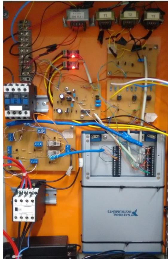
A placa de aquisição NI USB-6351, fabricada pela *National Instruments*, é a responsável pela leitura dos sinais de tensão e corrente de entrada do motor. Tal dispositivo é dotado de 16 entradas analógicas individuais que podem também ser usadas em pares no modo diferencial. Sete desses pares foram utilizados para realizar a coleta dos dados em tempo real.
