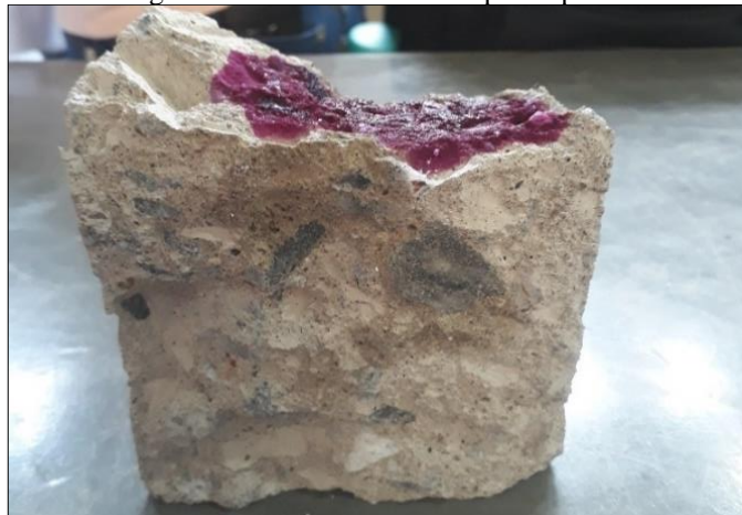
Figura 5: Fenolftaleína em corpo-de-prova.
