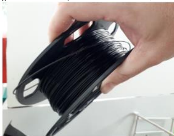
Figura 2. Fotografia do filamento produzido de PLA com 0,5% em massa de GO.
