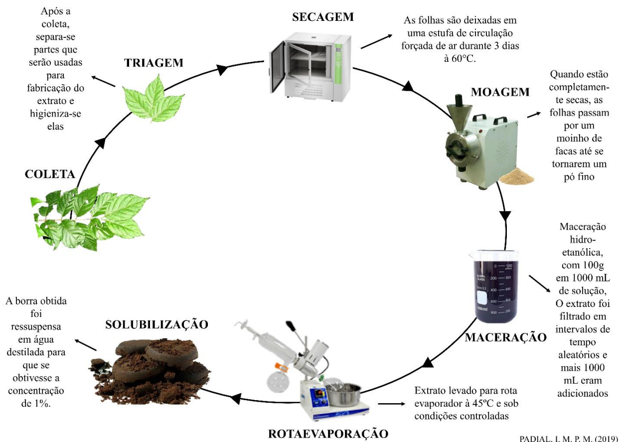
Figura 2. Passo a passo para confecção dos extratos hidroalcoólicos de S. camporum utilizados no ciclo biológico de P. xylostella em condições de laboratório à 25 \pm 1^\circ\text{C} , umidade relativa 70 \pm 5\% e fotoperíodo de 12 horas. Fonte: imagem adaptada de Padial et al. (2019).
