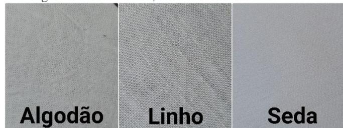
Os tecidos foram cortados em tamanhos iguais de 12 cm x 12 cm. Cada um deles foi devidamente identificado e inserido em um béquer de 500 mL, contendo 300 mL de água e 30 mL de sabão neutro de glicerina; ficando em repouso por 24 horas. Após o repouso os tecidos foram enxaguados em água corrente e colocados para secagem em temperatura ambiente.
