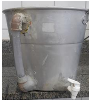
Figura 1 – Sistema clarificador do sebo bovino
