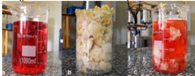
Figura 2 – Processo de desodorização do sebo bovino
