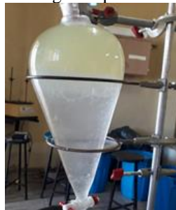
Figura 4 – Lavagem aquosa do sebo bovino
