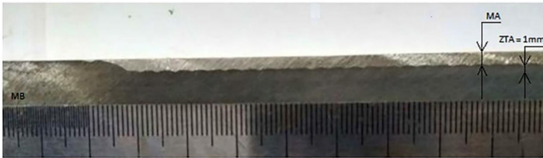
Figura 3: Macrografia da seção transversal apresentando as diferentes regiões do material soldado.
